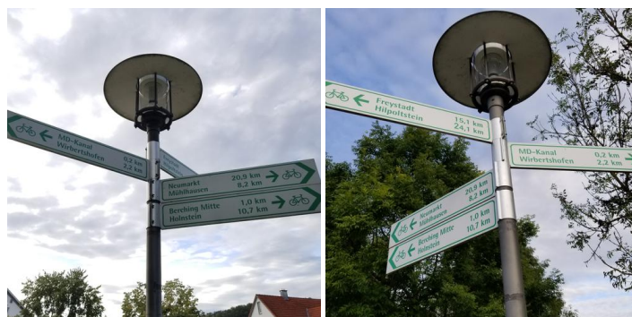
Demontage Rad Pfeil: 4 Beanstandung: nicht FGSV-konform
